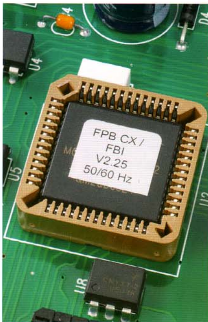
Das Eprom, das die elektrischen Parameter und die Temperatur überwacht sowie den Ruhestrom regelt, lässt sich updaten
